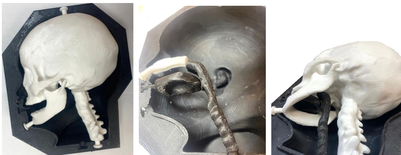
Рисунок 5.4 – Детали модели, закреплённые в нижней части литевой формы: череп (слева); вставки дыхательных путей (центр); череп с нижней челюстью и установленными вставками (справа)
