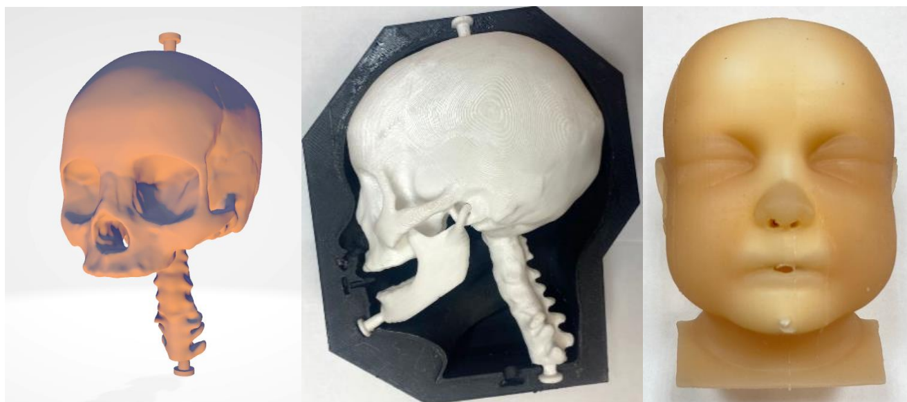
Рисунок 7 – 3D моделирование; детали в литейной форме; готовая модель
